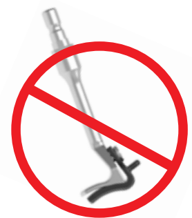
Abbildung 6 Den Einsatz nicht wie abgebildet verbiegen oder herausbrechen
